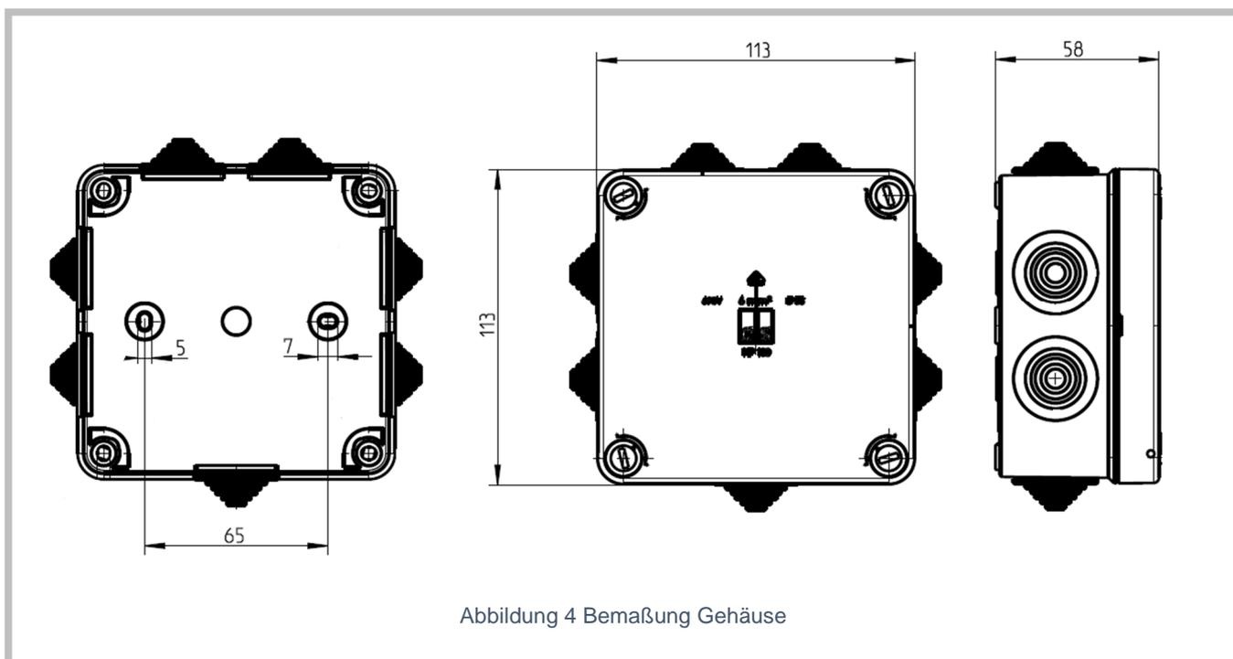
Abbildung 4 Bemaßung Gehäuse
