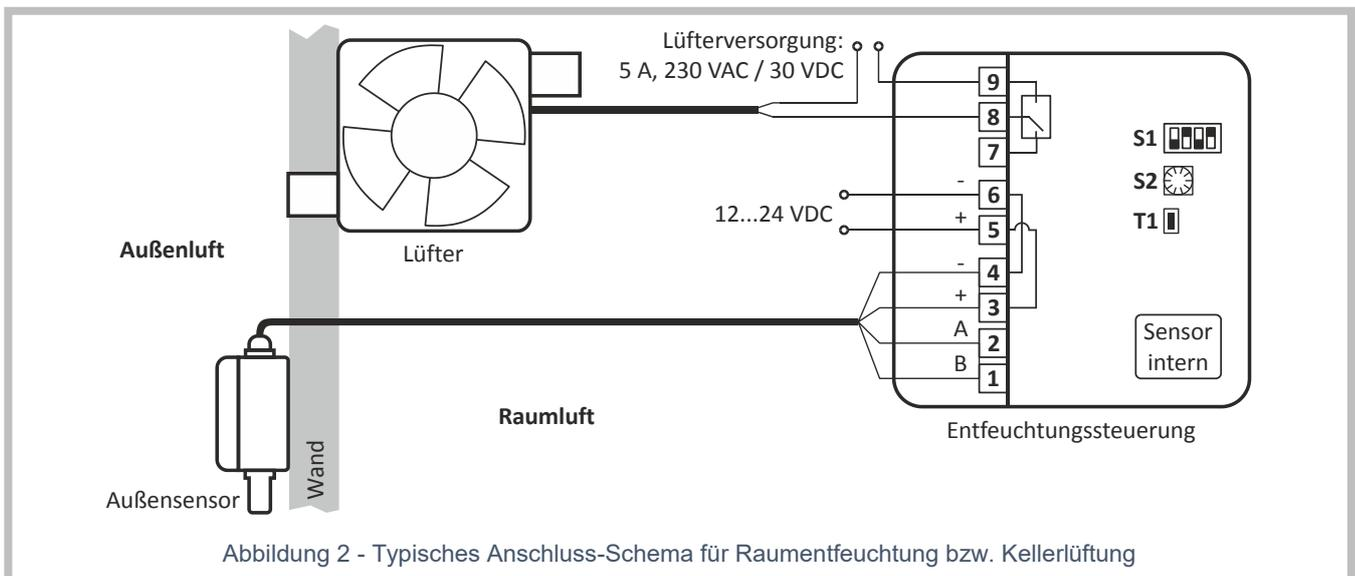
Abbildung 2 - Typisches Anschluss-Schema für Raumentfeuchtung bzw. Kellerlüftung
