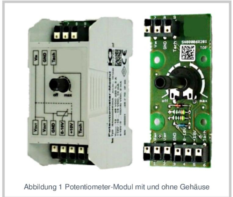
Abbildung 1 Potentiometer-Modul mit und ohne Gehäuse
